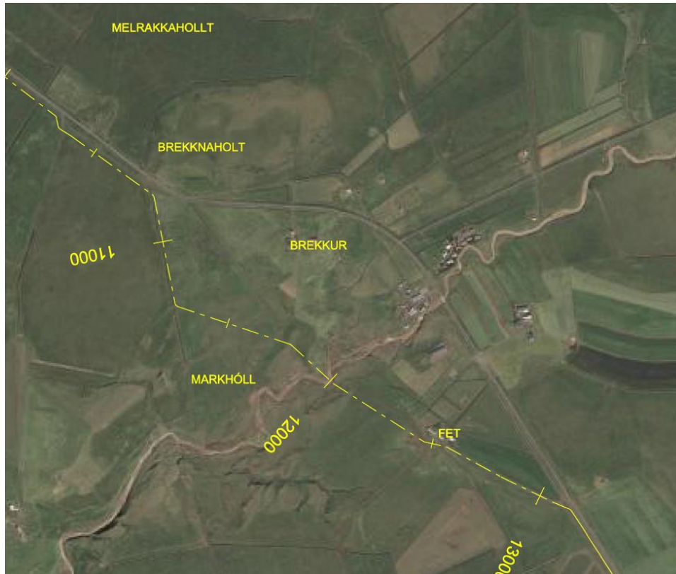
Mynd 2. Þverun Rauðalækjar 580 m neðan brúar á Hringvegi. Gul brotin lína táknar lagnaleiðina.
